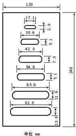
图 2 片状规准仪 (3mm 钢板做基板)
